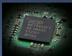
DSP de doble núcleo de punto decimal flotante de alta velocidad de 32 bits
