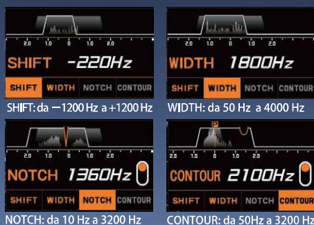
SHIFT: da -1200 Hz a +1200 Hz WIDTH: da 50 Hz a 4000 Hz NOTCH: da 10 Hz a 3200 Hz CONTOUR: da 50Hz a 3200 Hz
