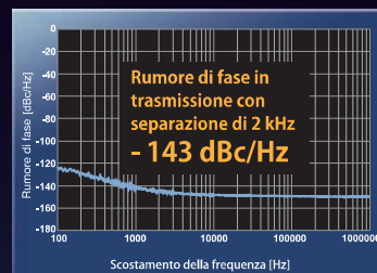
Rumore di fase TX (banda dei 14 MHz, TX 100W, Modalità: CW)
