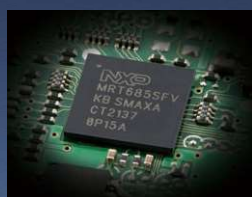
DSP dual-core, a virgola decimale mobile ad alta velocità a 32 bit
